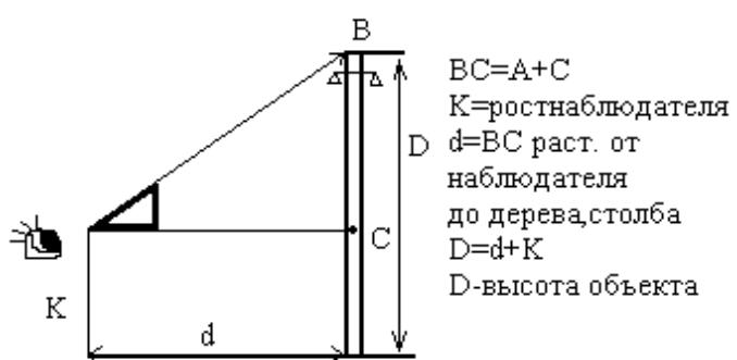
**Определение расстояний на глаз.** Надо знать высоту объекта, до которого измеряем рассеяние. Пример: рост человека около 1,6-1,8м., труба Благовещенской ТЭЦ-190м., 5-этажного здания 15-18м., столб ЛЭП деревянный-6м.
