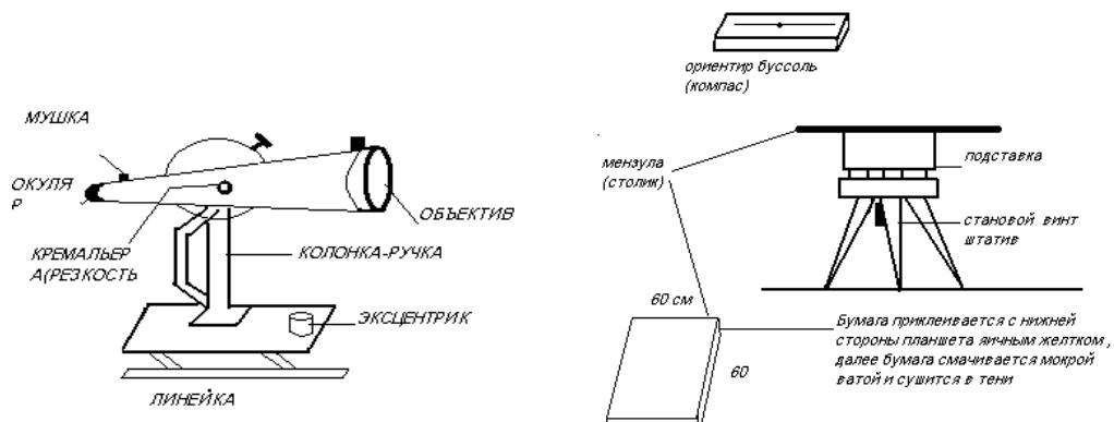
**Кипрегель автомат (КА-2).** Автомат означает, что превышения определяются автоматически и высвечиваются в окуляре.
