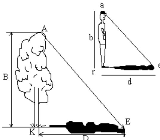
$$AK/ar = KE/re; \quad AK = ar \cdot KE/re \quad \text{где } AK - \text{высота дерева (B)}$$
