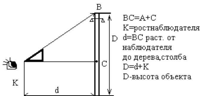
**Определение расстояний на глаз.** Надо знать высоту объекта, до которого измеряем рассеяние. Пример: рост человека около 1,6-1,8м., труба Благовещенской ТЭЦ-190м., 5-этажного здания 15-18м., столб ЛЭП деревянный-6м.
