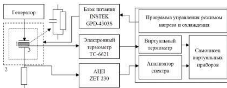
Рис. 1. Схема экспериментальной установки для исследования сегнетоэлектриков методом НДС. Образец представлен в виде эквивалентной схемы с сопротивлением R и емкостью C : 1 – исследуемый образец, 2 – термостат, 3 – термопара
